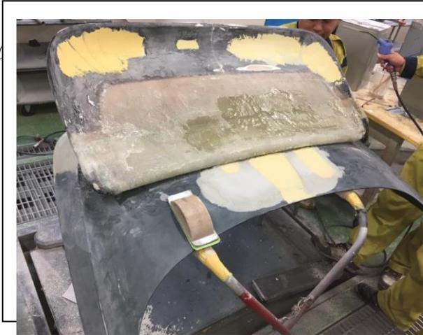
トランクも製作。スポイラーは適当なものをベースに幅短縮、長さ延長して製作。
